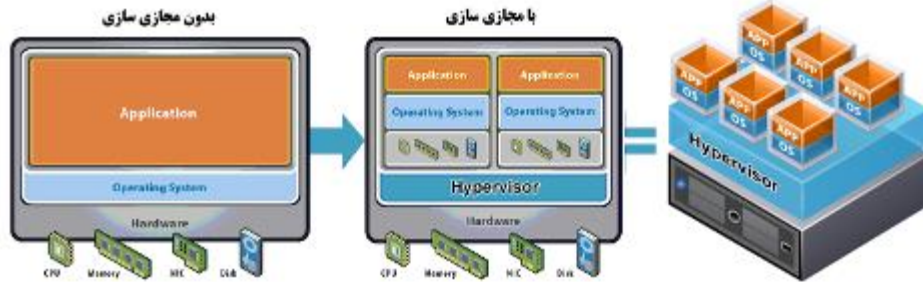
شکل ۷-۱- نمایی از مجازی سازی: ایجاد استقلال در برنامه‌های کاربردی، سرویس‌ها و سیستم‌های عامل از سخت‌افزاری که در آن اجرا می‌شوند.
