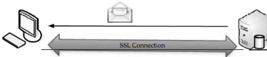
شکل ۷-۳-۱- برقراری یک ارتباط SSL بین کاربر و سرویس دهنده ابری
